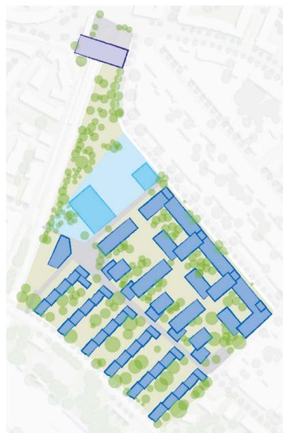
Freiraum entlang den Gleisen. Im Wasserwerk wird die Anordnung beibehalten und mit Kopfbauten ergänzt. Auf dem Lettenplateau entstehen Siedlungen um mehrere Höfe. Schule als Einstieg ins Quartier.
